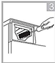
Reinigen Sie die Innenseite der Aussparung mit einer alten Zahnbürste
