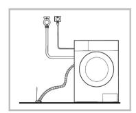
2. Schließen Sie es an das Abflussrohr des Trogs an.
